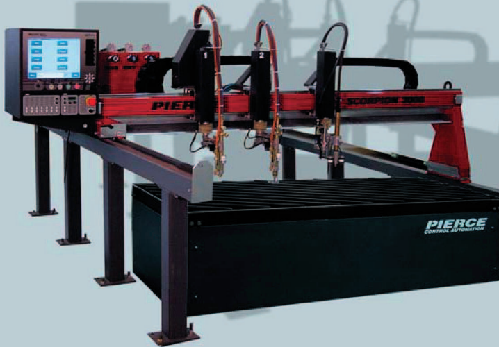
SCORPION – CNC rezací stroj pre autogénne a plazmové rezanie
